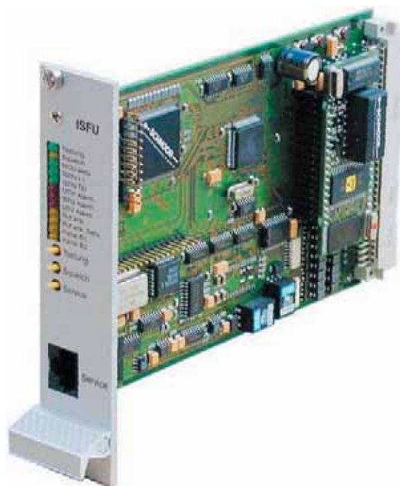
ISDN-Endgerätebaugruppe ISFU (ISDN-Funkanschaltung)
